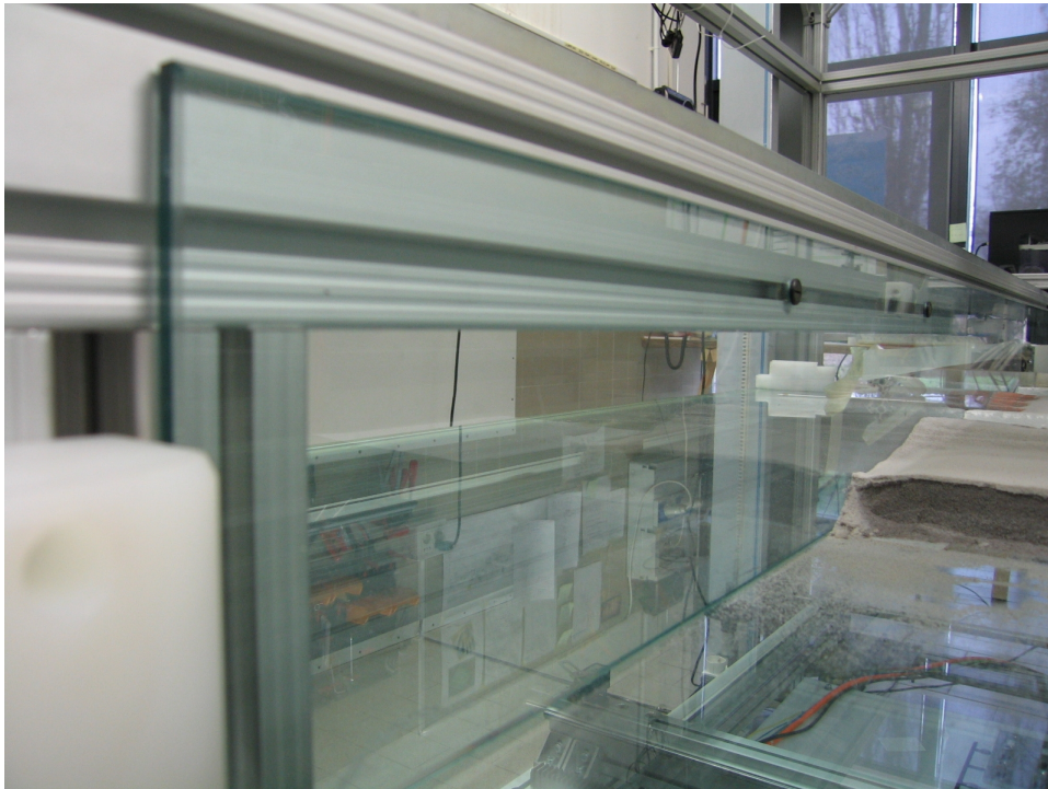
Figura 4.5. Pareti di contenimento laterale in cristallo
