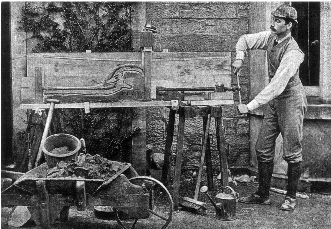
Figura 3.2 Scatola di deformazione con modellino in argilla ( fonte internet)
