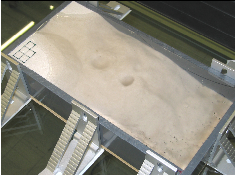
Figura 4.29 Modello pilota riempito di silicone
