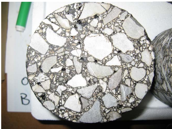
Figura 1.6 – Influenza della posizione degli inerti sulla resistenza a trazione indiretta
