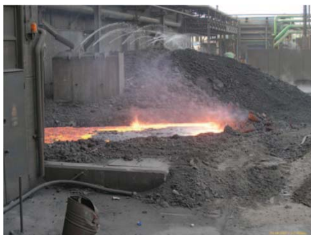
Figura 4.7 – Processo di raffreddamento della scoria
