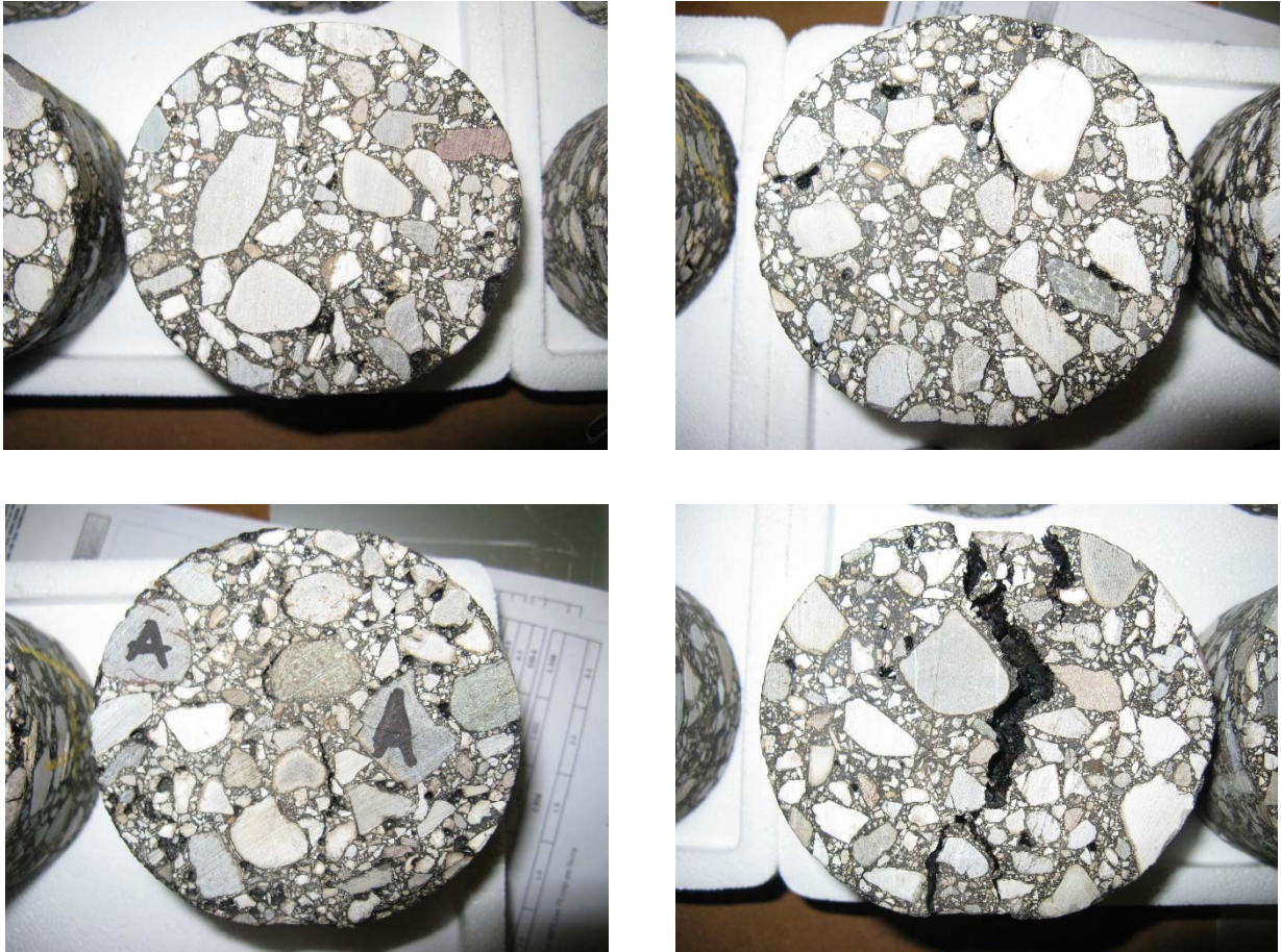
Figure 1.7 – Varie tipologie di rottura per trazione indiretta
