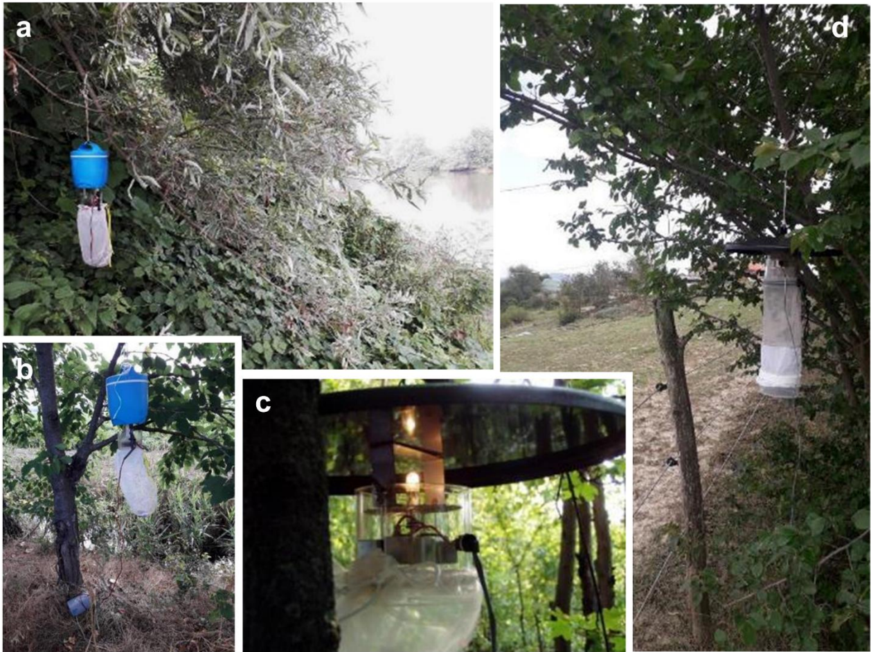
Figura 5 — Modelli di trappola utilizzati per la cattura degli insetti, Trappola CO 2 (modello CAA), il termos blu è forato e contiene ghiaccio secco che sublimando produce anidride carbonica, sotto al termos è posizionata una ventola a batteria (12 volt) che aspira le zanzare nel retino (a, b). CDC miniatura light trap, la fonte luminosa è costituita da una luce a incandescenza, la ventola è attivata da una batteria da 6 volt.
