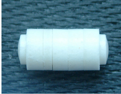
Figura 31: Formulazione #C3 assemblata in 5 moduli.
