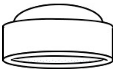
Figura 4. Modulo Dome Matrix ® : compressa avente caratteristica forma di disco con una base concava e una convessa la cui sezione assiale appare come una cupola
