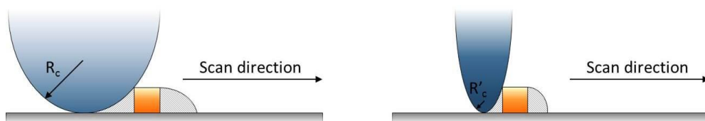
Figura 1.15. Maggiore è il raggio di curvatura della punta ( R_c > R'_c ), maggiore sarà il "cono d'ombra" generato attorno all'oggetto scansionato ed il conseguente effetto di allargamento provocato dalla punta durante la creazione dell'immagine.
