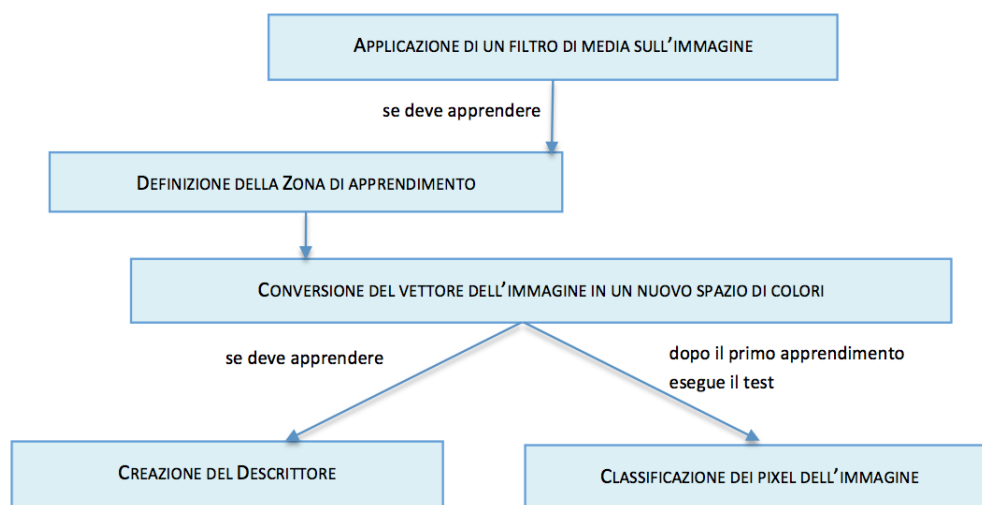
Figura 4.3: Diagramma rappresentante l'algoritmo di rilevazione della superficie stradale.
